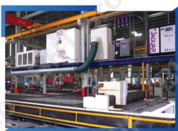
Máy cắt laser Laser Cutting Machine
