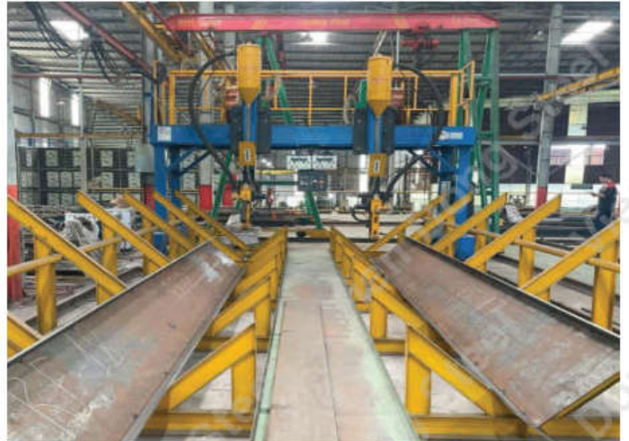
Máy hàn xướng Fillet Welding Machine
