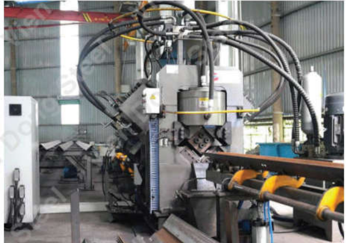
Máy cắt sắt V V-Angle Steel Cutter
